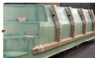
< 07 > Placement des renforts cartonnés
