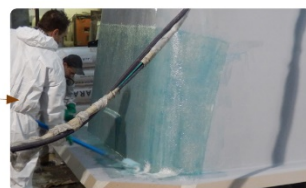
< 05 > Moulage résine ISO + Rovimat 450x500
